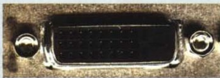
Il connettore DVI a 24 poli è in grado di trasferire segnali sia digitali, sia analogici; è per questo in grado di pilotare anche monitor dotati di solo ingresso analogico. La risoluzione massima è superiore a 1280 x 1024.
